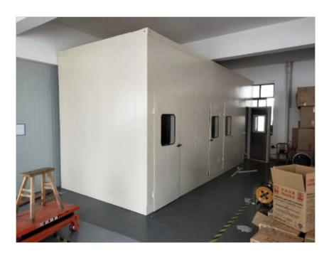
隔音房采用隔音与降噪治理的具体措施根据工业厂房各项目的具体情况,隔音及降噪应在项目设计及施工 阶段及早入手,从声源、传声途径这两个环节采取技术措施。对于主要噪声源的机械设备根据需要可以加装隔 音房,从噪声源头降低噪声辐射。隔音房是把噪音较大的装置密封起来,因此它是一种较有效可取的降噪措施, 可以较大限度的阻隔噪声的外传。隔音房在不影响生产工艺的情况下,优化噪声控制设计,对主要声源,应多 管齐下,综合考虑,从多角度处理,可以降低经济成本。
